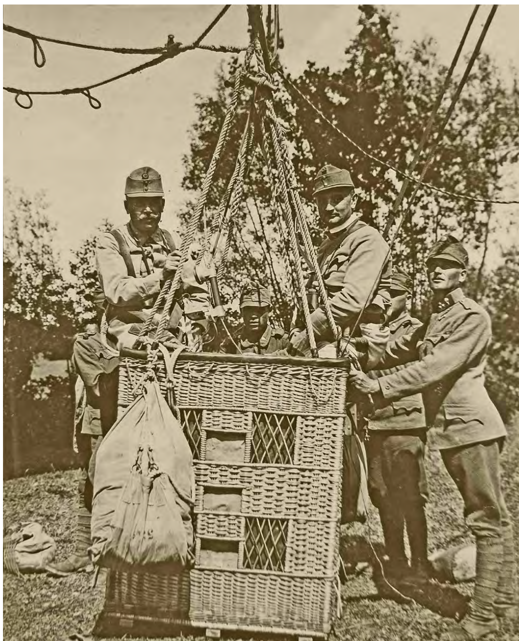
CESTO E OSSERVATORI. IN PRIMO PIANO, IL PARACADUTE AGGANCIATO ALL'ESTERNO. SI NOTINO IL TELEFONO E LA CESTA LEGGERA MA ROBUSTA IN VIMINI. GLI OPERATORI INDOSSANO LA DIVISA ORDINARIA. COME TESTIMONIANO LE PIANTE SULLO SFONDO SI È NELLA BELLA STAGIONE E ANCHE IN QUOTA LA TEMPERATURA È SOPPORTABILE
