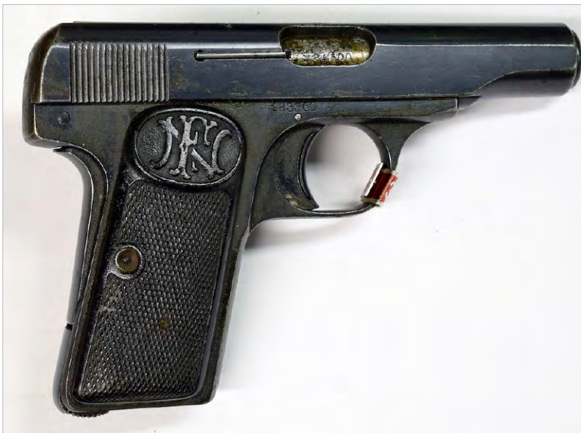
PISTOLA SEMIAUTOMATICA A MASSA BATTENTE PROGETTATA DA JOHN BROWNING E PRODOTTA DALLA BELGA FABRIQUE NATIONALE DE HERSTAL (FN). UNA FN MODÈLE 1910 BROWNING È ESPOSTA NELLA SALA DELLA GRANDE GUERRA - MUSEO STORICO DELL'ARMA DEI CARABINIERI
