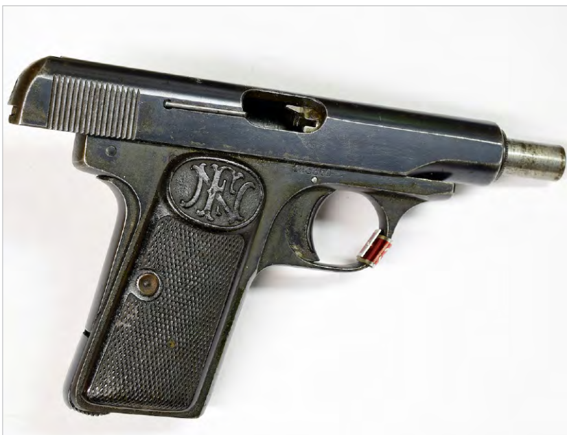
PISTOLA SEMIAUTOMATICA A MASSA BATTENTE PROGETTATA DA JOHN BROWNING E PRODOTTA DALLA BELGA FABRIQUE NATIONALE DE HERSTAL (FN). UNA FN MODÈLE 1910 BROWNING È ESPOSTA NELLA SALA DELLA GRANDE GUERRA - MUSEO STORICO DELL'ARMA DEI CARABINIERI
