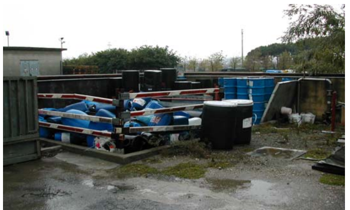
Bidoni con residui di sostanze pericolose su terreno non pavimentato – S.ta Croce sull'Arno.
